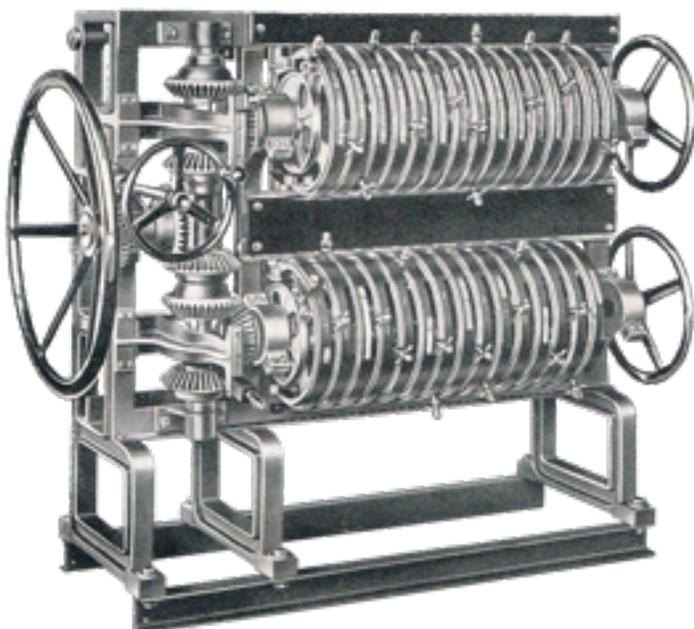
Bild 10: Dieses AEG-Stellwerk wurde in zwei verschiedenen Verwendungen eingesetzt, einmal als Stellwerk für drahtseilgeführte Helligkeitsregler (Rheostaten) und zum anderen als Stelleinheit für die damals üblichen Seilzuglaternen oder Farb- und Abdeckscheiben der Beleuchtung der Rundhorizontanlagen der Bauart AEG.
