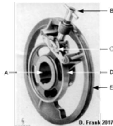
Bild 14: Gegenlaufkupplung von SIEMENS mit Hebelscheibe
