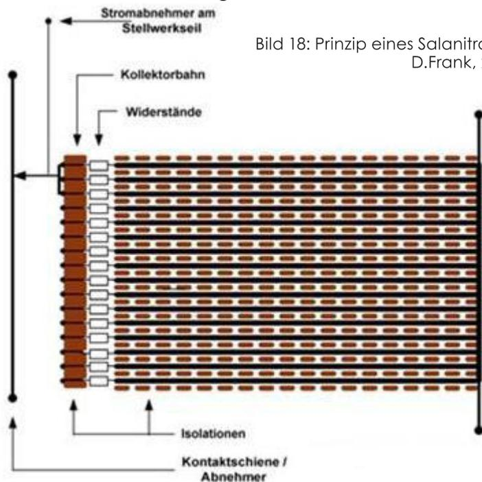
Bild 18: Prinzip eines Salanitrafos. D.Frank, 2017
