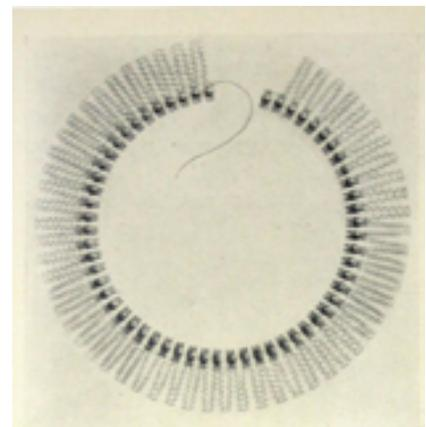
Die Widerstandswicklungen waren eingebettet in eine Art Kunstharz (Enamel) oder in Specksteinplatten montiert. Die relativ schmale Bauweise der einzelnen Dimmer ermöglichte unterschiedlichste Konstruktionen von „Stellwerken“, oft in Kombination mit groß ausgelegten Schaltanlagen.
