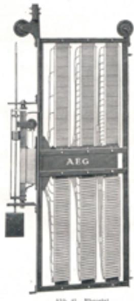
Bild 4: Einzelrheostat mit 100 Stufen und für Spannungen von 110 V oder 220 V DC und max. 60 A. AEG
