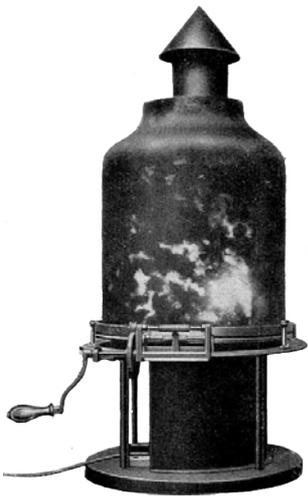
Bild 1: Wolkenapparat der AEG 1889, Handantrieb, die Leistung der verwendeten Lichtbogeneinrichtung ist nicht bekannt.
