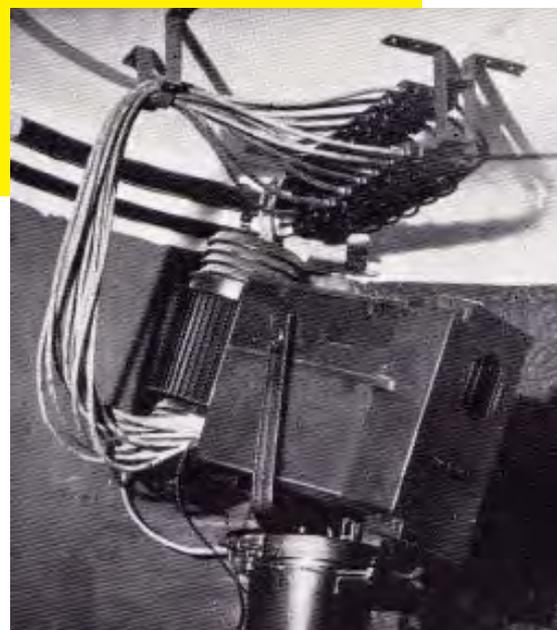
Bild 14: Eine weitere Ausführung des steuerbaren Scheinwerfers der Firma Schwabe & CO. Berlin, um 1929
